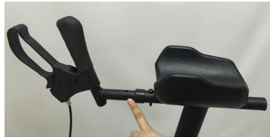
bremser/håndtaget og gigtstøtten skal du skrue møtrikken af under støtten og fjerne skruen ovenfra. Træk håndtaget ud, indtil den ønskede afstand er nået, og sæt møtrikken tilbage i åbningen ovenfra. Skub det hele vejen ind, og stram møtrikken igen nedefra. Afstanden skal være den samme på begge sider.
