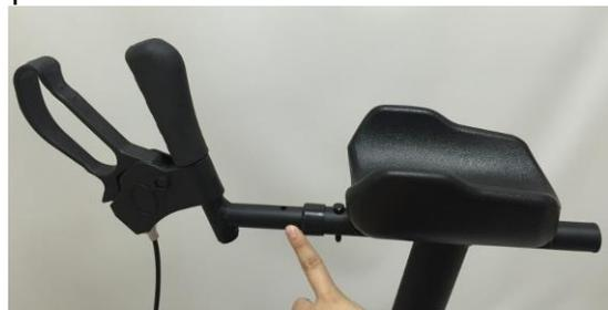
y el soporte de artritis, desenrosque la tuerca situada debajo del soporte y retire el tornillo desde arriba. Tire de la empuñadura hacia fuera hasta alcanzar la distancia deseada y vuelva a introducir la tuerca en la abertura desde arriba. Empújela hasta el fondo y vuelva a apretar la tuerca desde abajo. La distancia debe ser la misma en ambos lados.
