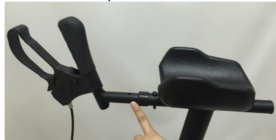
l'arthrite, dévissez l'écrou sous le support et retirez la vis par le haut. Tirez la poignée vers l'avant jusqu'à ce que la distance souhaitée soit atteinte et replacez l'écrou dans l'ouverture par le haut. Introduisez-le à fond et revissez l'écrou à fond par le bas. L'écart doit être le même des deux côtés.
