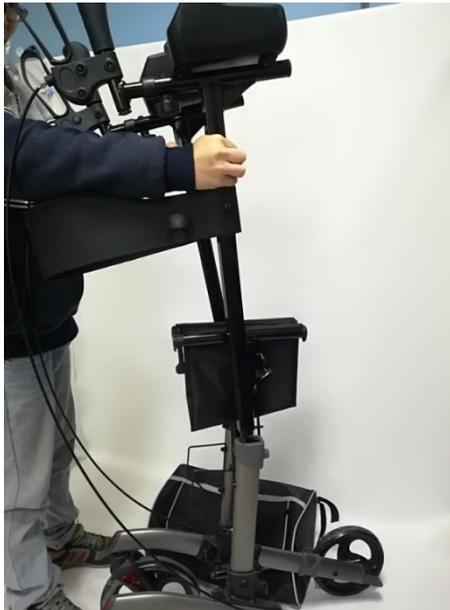
3. Steek de buizen met de artritissteunen in de framedelen van de standaard. Draai hier de knopschroef op de buissteun los, duw of trek de handgreepbuis naar de gewenste hoogte (bevestigingsgaten) en draai de knopschroef weer vast. Zorg ervoor dat aan beide zijden dezelfde hoogte wordt ingesteld. De remkabels lopen parallel aan het frame.
