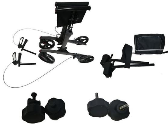
3. Inserire i tubi con i supporti per l'artrite nelle parti del telaio dello stativo. Allentare la vite della manopola sul supporto del tubo, spingere o tirare il tubo dell'impugnatura all'altezza desiderata (fori di fissaggio) e stringere nuovamente la vite della manopola. Assicurarsi di impostare la stessa altezza su entrambi i lati. I cavi dei freni corrono paralleli al telaio.
