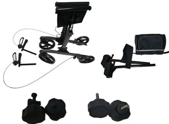
3. Indsæt rørene med gigtstøtterne i stativets rammedele. Løsn knopskruen på rørstøtten her, skub eller træk håndtagsrøret til den ønskede højde (huller til fastgørelse), og stram knopskruen igen. Sørg for, at højden er den samme på begge sider. Bremskablerne løber parallelt med stellet.
