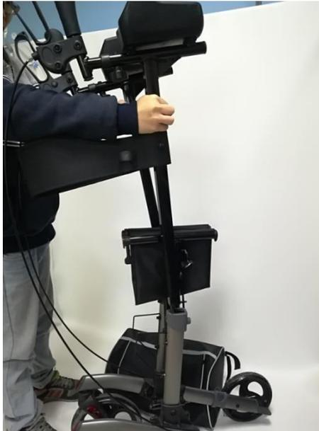
3. Stecken Sie Rohre mit den Arthritis-Auflagen in die Rahmenteile des Gestells. Lösen Sie hier die Knopfschraube an der Rohrhalterung, schieben oder ziehen das Griffrohr auf die gewünschte Höhe (Löcher zur Fixierung) und ziehen die Knopfschraube wieder fest an. Achten Sie darauf, dass auf beiden Seiten die gleiche Höhe eingestellt ist. Die Bremszüge verlaufen parallel zum Rahmen.
