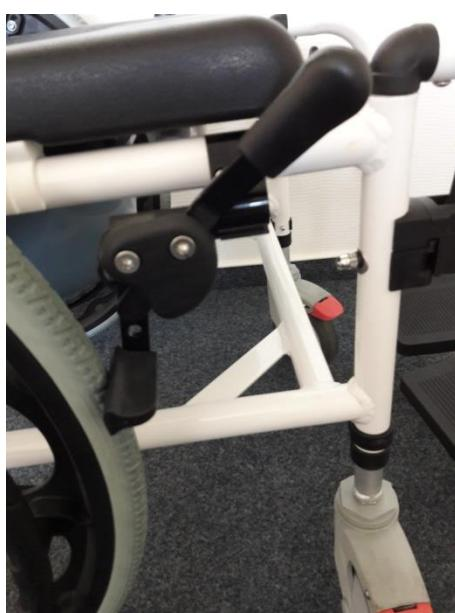
5. Lås bremsen ved at vippe bremsearmene på baghjulene fremad. På forhjulene trykkes de røde klapper ned.
