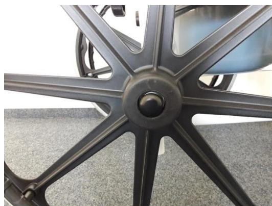
Para aflojar las ruedas traseras, presione el mecanismo de sujeción rápida del centro de la rueda!
