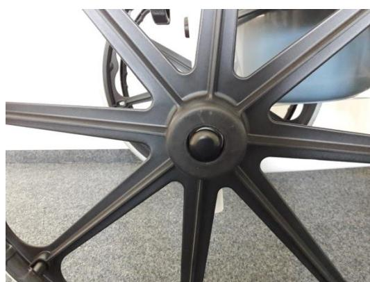
Zum Lösen der Hinterräder drücken Sie auf den Schnellspann-Mechanismus in der Mitte des Rades.
