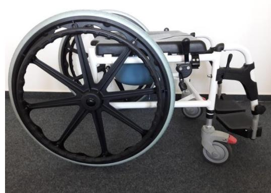
5. Fixieren Sie die Bremse, indem Sie die Bremshebel an den hinteren Rädern nach vorne kippen. An den vorderen Rädern drücken Sie die roten Hebel nach unten.
