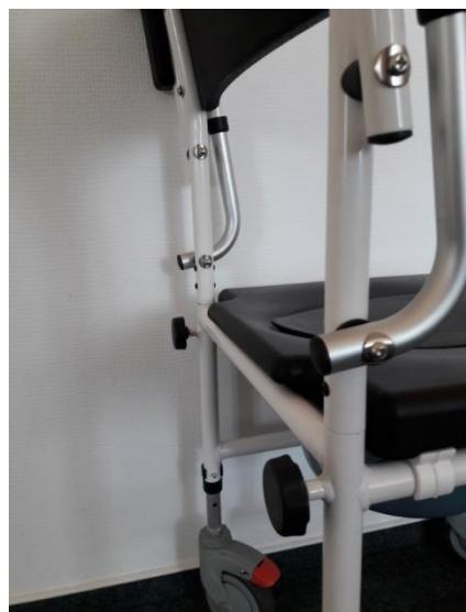
6. Stecken Sie die unteren Rohrenden der Rückenlehne in die rückseitigen Öffnungen des Gestells und fixieren Sie diese mit den beiden Knopfschrauben. Klappen Sie die Armlehnen nach unten.
