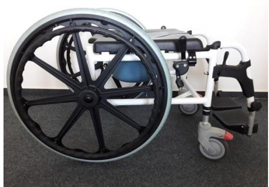
5. Bloccare il freno inclinando in avanti le leve del freno sulle ruote posteriori. Sulle ruote anteriori spingere verso il basso le leve rosse.
