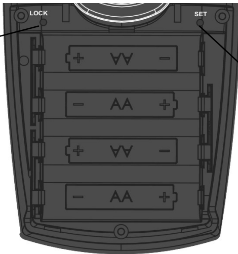
Schema zur Anordnung der 4 Batterien des Typs AA
