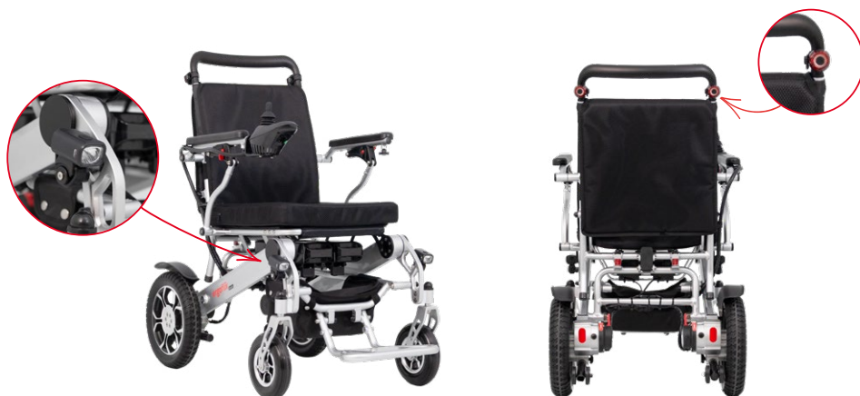
Abb. 9: Einstellung und Montage des mitgelieferten Beleuchtungs-Sets
