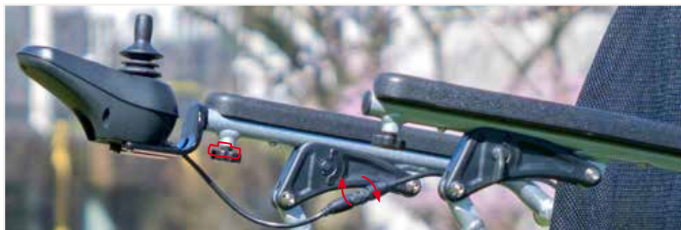
Abbildung 5: Das Bedienmodul fixieren und verbinden.
